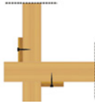
Abb. 66: Sichern von Kreuzholzstapel
