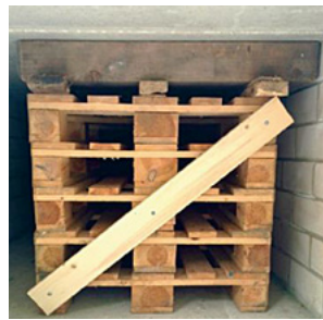
Abb. 71: Beispiel eines korrekt aufgebauten Palettenstapels (Blockhaus, THW)
