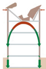
Abb. 1: Kraftableitung in die Fundamente (Wellenhofer, THW)
