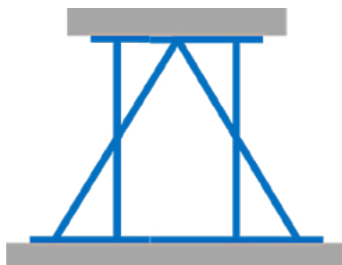
Abb. 53: Aussteifung eines Flächentragwerks mit einer A-Verstrebung
